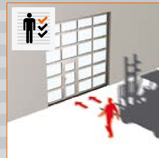
Porte d'accès pour personnes intégrée dans la porte sectionnelle destinée aux marchandises.
