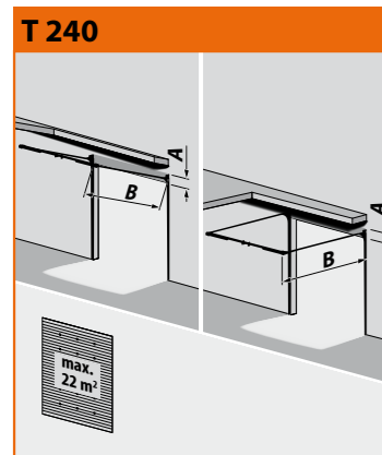
T 240 Système de rails à linteau réduit, câbles glissés à l'intérieur + profilé de support en acier A= 240 mm B= hauteur du jour + 1 000 mm Largeur est max. 6.500 mm
