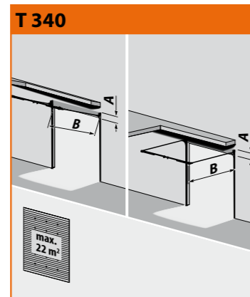
T 340 Système de rails normal, arbre-ressort arrière + profilé de support en acier A= 340 mm B= hauteur du jour + 750 mm Largeur est max. 6.500 mm
