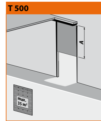
T 500 Système de rails vertical A= hauteur du jour + 560 mm, B= non applicable
