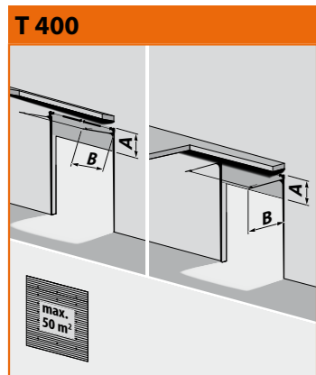
T 400 Système de rails levée semi-verticale A= élévation + 400 mm, B= hauteur du jour - élévation + 600 mm
