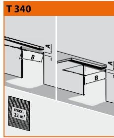
T 340 Système de rails normal, arbre-ressort arrière + profilé de support en acier
