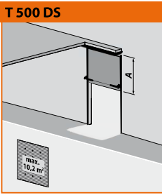
T 500 DS Système de rails vertical avec axe de ressort surbaissé
