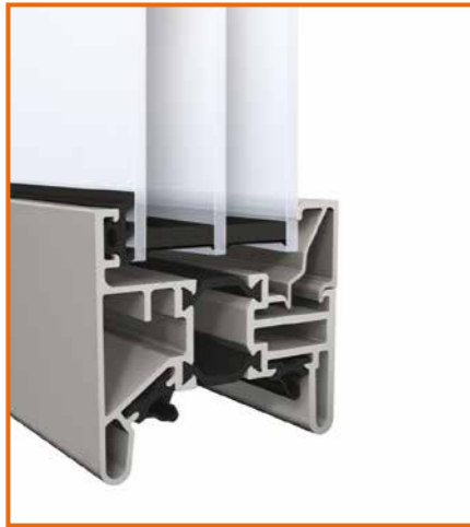
Panorama-Tor 60 mm Plexiglas-Dreifachscheiben Optical 40 mm (4-14,75-2,5-14,75-4 mm)
