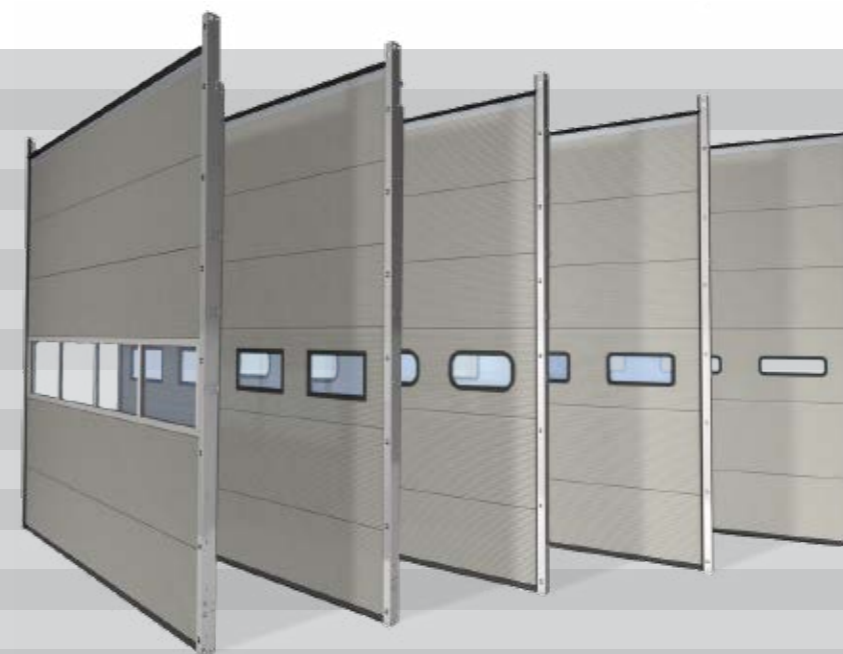
U-Wert ISO 40 mm Sektionaltor: 5000 x 5000 mm: 0,99 W/m²K
