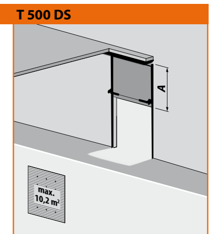
Pionowy system prowadnic z obniżonym wałem sprężynowym
