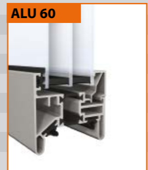
ALU 60 Panorama-Tor 60 mm Plexiglas-Dreifachscheiben Optical 40 mm (4-14,75-2,5-14,75-4 mm)
